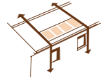
> Implantation horizontale. Alignement du champ de capteurs avec les ouvertures en façade.
